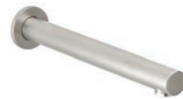
17.142000.3.09 Wandauslauf ½" Auslauf Ø 28 mm | Rosette Ø 52 mm erhältlich in 3 Auslaufängen: → 160 mm / → 210 mm / → 240 mm wall spout Ø 28 mm | rosette Ø 80 mm available in 3 lengths
