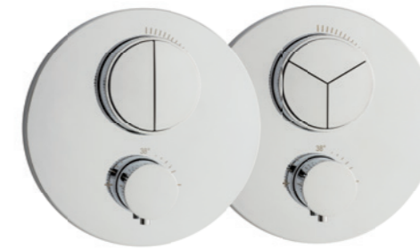
11.803050.1.01 / 11.803055.1.01 Thermostatmischer PUSH Unterputz round Farbset Wandmontage für 2 oder 3 Verbraucher mit PUSH-Buttons Heißwassersperre 38° C | Blende Ø 150 mm concealed thermostat mixer with push buttons final assembly set for 2 or 3 consumer safety stop at 38° C | cover Ø 150 mm
