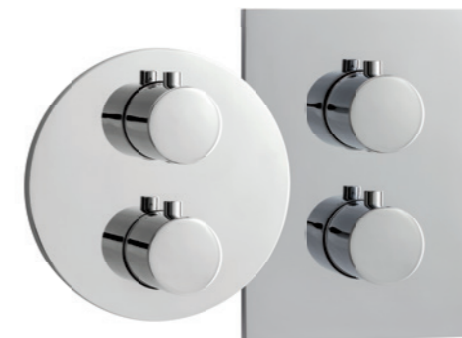
11.500550.1.01 / 11.500550.3.01 Thermostatmischer Unterputz Farbset Wandmontage für 1, 2 oder 3 Verbraucher Heißwassersperre 38° C Blende Ø 150 mm / 180 x 130 mm concealed thermostat mixer final assembly set for 1, 2 or 3 consumer safety stop at 38° C cover Ø 150 mm / 180 x 130 mm
