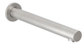
17.142000.3.09 Wandauslauf 1/2" Auslauf Ø 28 mm | Rosette Ø 52 mm erhältlich in 3 Auslaufängen: → 160 mm / → 210 mm / → 240 mm wall spout Ø 28 mm | rosette Ø 80 mm available in 3 lenghts
