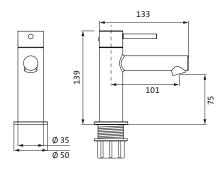
Lochbohrung Ø 35 mm hole diameter
