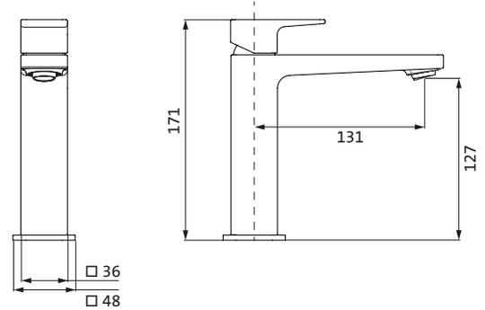
Lochbohrung  $\varnothing$  35 mm
