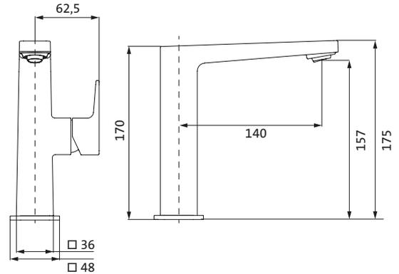
Lochbohrung  $\varnothing$  35 mm
